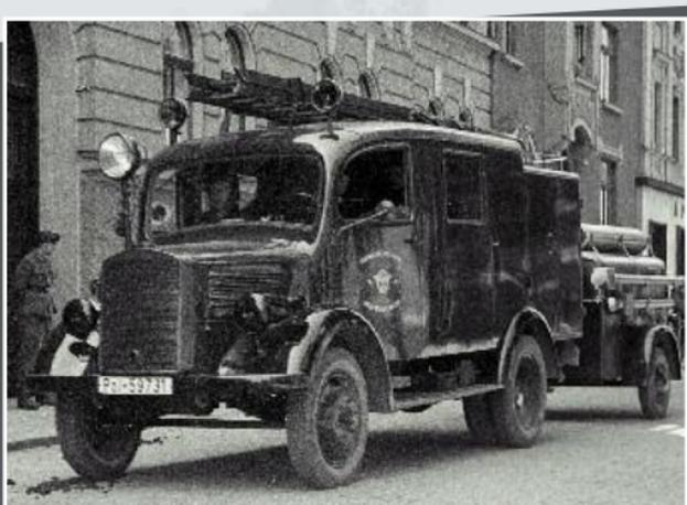
*Das Bild zeigt ein baugleiches LF 8 der FF der Stadt Wels, wie es während des Zweiten Weltkrieges zum Einsatz kam. Angehängt ist hier ein TSA, der aber einen Exhaustor (Be- und Entlüftungsgerät) statt einer Tragkraftspritze trägt.
